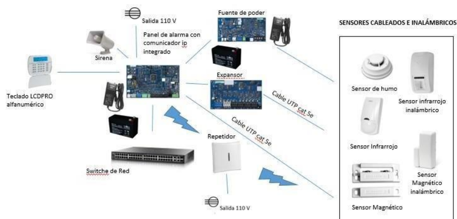
Ilustración 3. Arquitectura del sistema de alarma de intrusión
