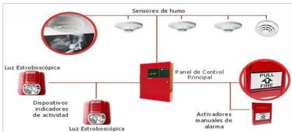
Ilustración 9. Esquema del sistema de detección de incendio
