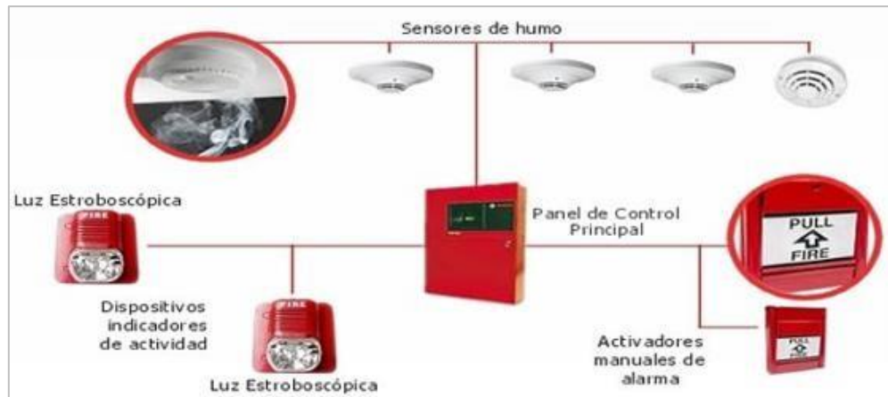
Ilustración 9. Esquema del sistema de detección de incendio
