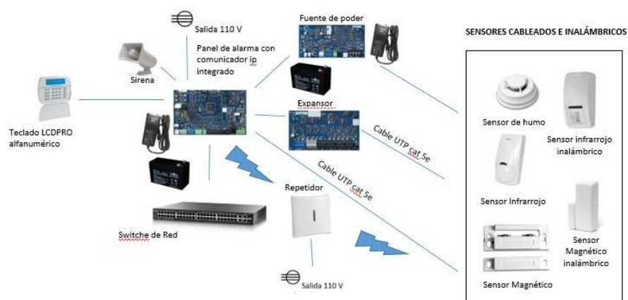
Ilustración 3. Arquitectura del sistema de alarma de intrusión
