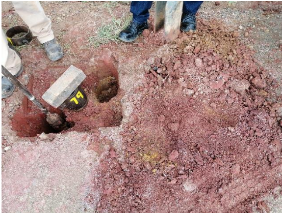
Foto 8 Hincado del molde de CBR Fuente: El Autor
