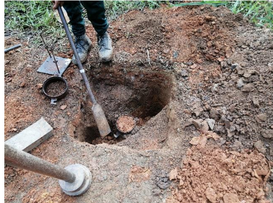
Foto 9 Extracción del molde de CBR Fuente: El Autor
