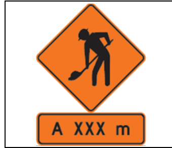
Figura 14. Señal de trabajos en la vía
