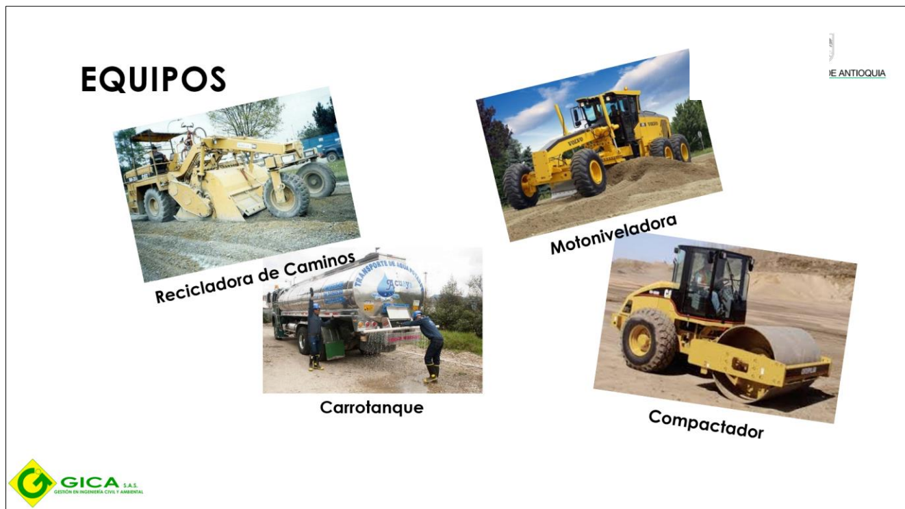
Figura 5. Equipos empleados para la construcción de capas de MGTC
