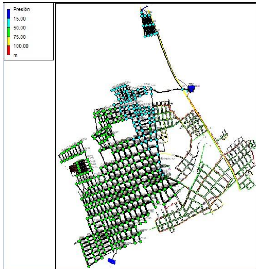
Escala de colores para los resultados de presión durante el periodo de menor consumo.
