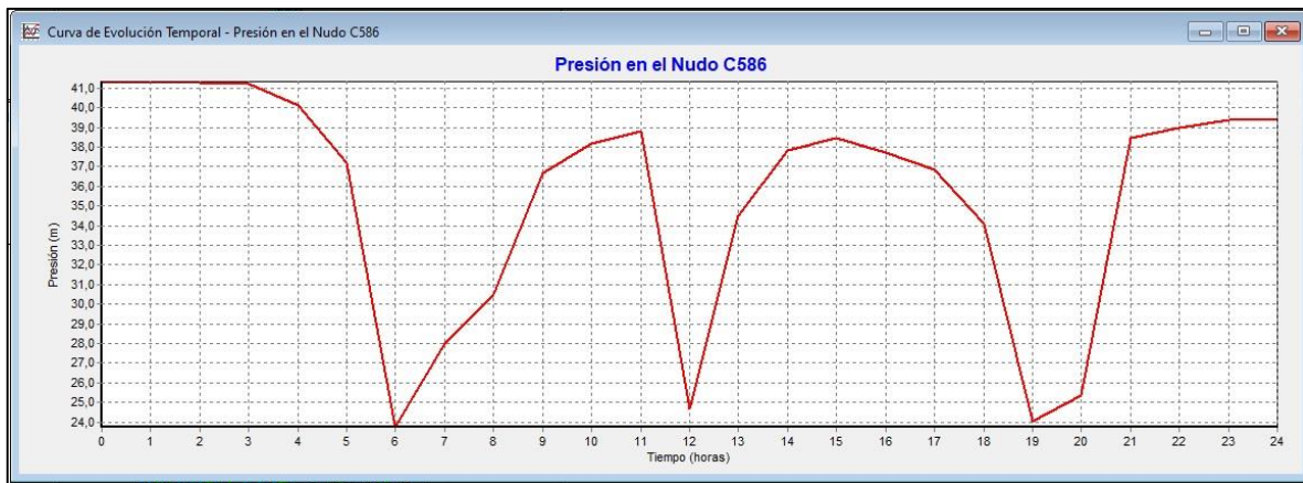
Curva de evolución temporal de la presión en la conexión C586.
