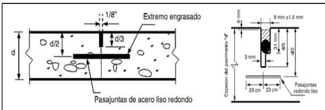
Figura 14. Detalle de junta transversal. Fuente: Manual Pemex para diseño de pavimentos en concreto rígido. 2004.
