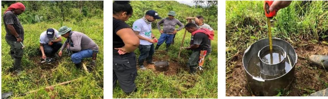
**Figura 5. Montaje para determinar las características de la infiltración en el suelo mediante infiltrómetro de doble anillo.**
