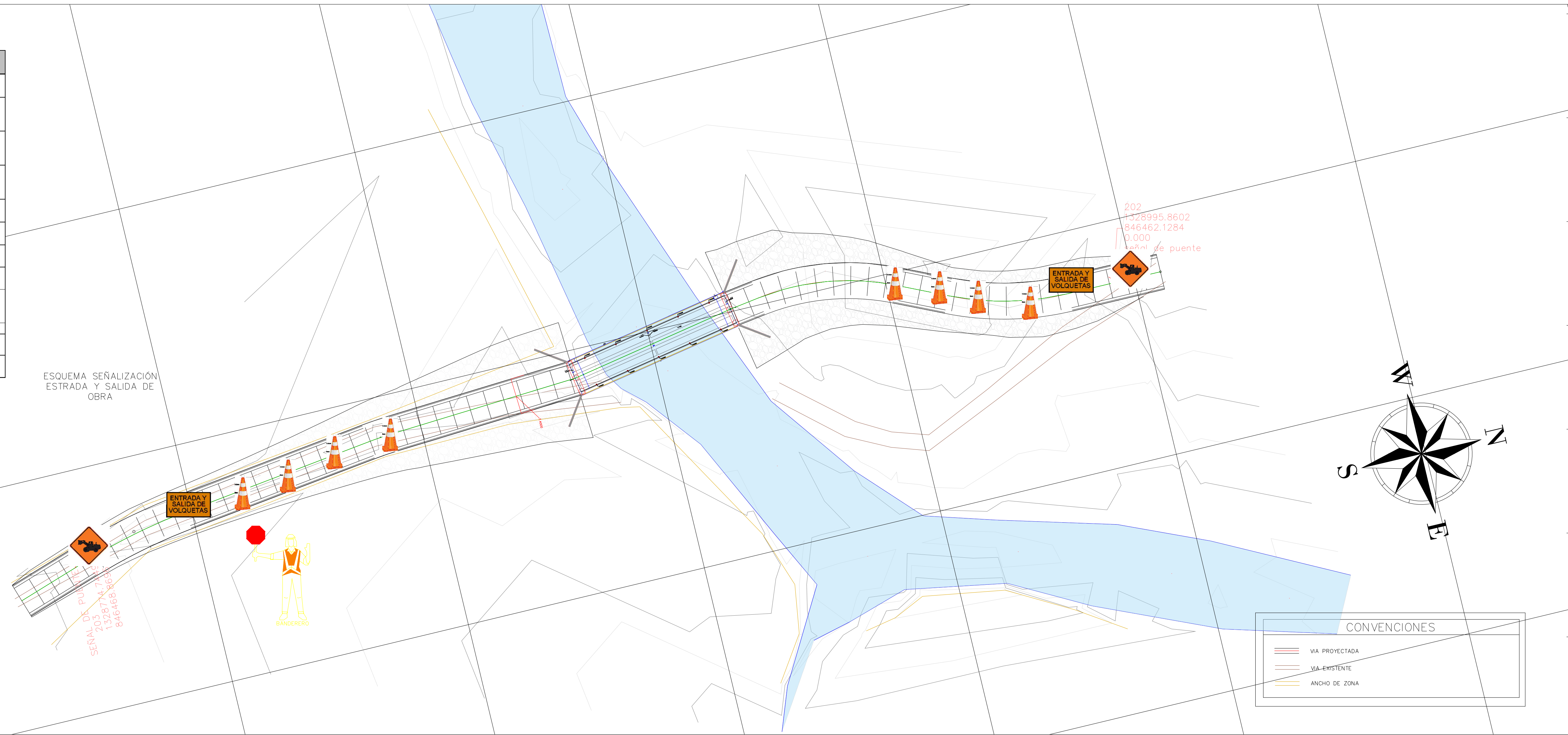
Plano tipo PMT Intervención calzada sencilla bidireccional medio rural - cierre carril izquierdo
