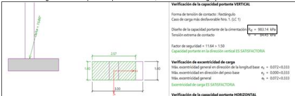
Figura 10-26 Capacidad portante última, condición de carga permanente
