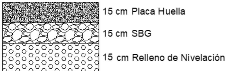
Ilustración 1. Solución Estructural Placa Huella.
