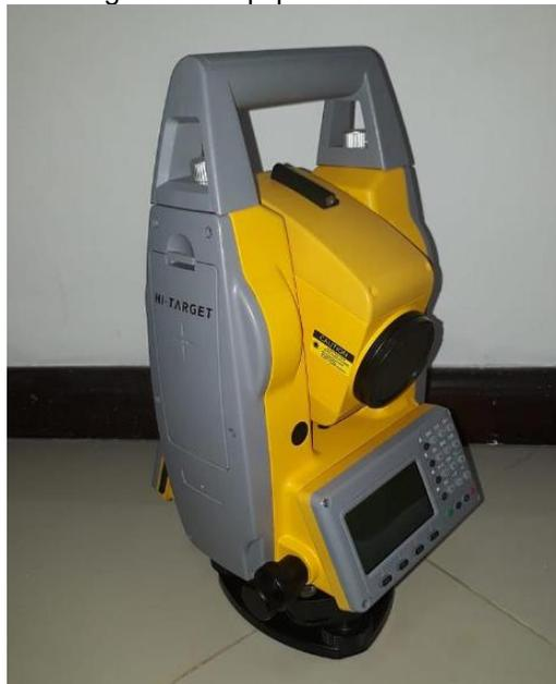
Para el levantamiento topográfico del proyecto en mención, se hizo uso de una estación marca HI-TARGET de referencia ZTS-320R con serial Z120554, con una precisión de angular de 2" seg.
